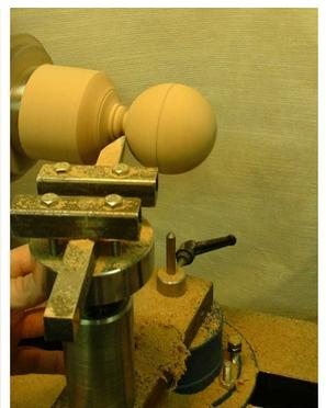
Système de mise en place et de blocage rapide. Une traverse est solidaire, par l'intermédiaire d'un axe, d'un excentrique de selle de vélo. Tout d'abord la traverse est parallèle au banc du tour, on met en place la sphéreuse. On tourne de 90° l'excentrique : la traverse se met en travers du banc. On abaisse l'excentrique : la traverse remonte et se bloque contre le banc, la sphéreuse est ainsi immobilisée.
